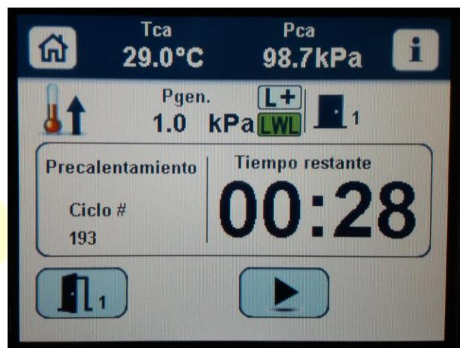
Ya terminado el precalentamiento, nos aparecerá en la pantalla otro programa para realizar Test B&D, para abrir y cerrar la puerta del esterilizador nos aparece un ícono en la pantalla con un dibujito de una puerta el cual pulsamos y esperamos unos segundos a que ésta se abra para introducir el paquete B&D y volvemos a pulsar el ícono de la puerta continuamente hasta que quede cerrada por completo.
